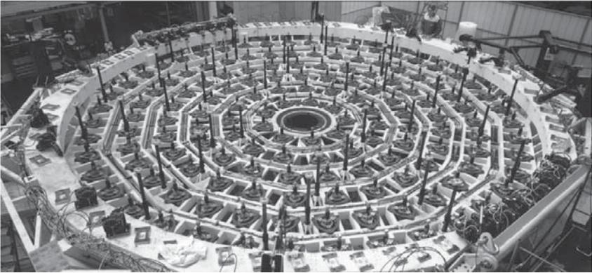
Рис. 6.3. Оправа 8,2-м главного зеркала одного из телескопов VLT Европейской южной обсерватории. Видна система разгрузки и управления формой зеркала при помощи актюаторов. Для контроля за формой зеркала используется датчик волнового фронта с разрешением  $30 \times 30$
