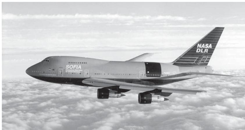
Рис. 5.2. Летаящая обсерватория SOFIA (Stratospheric Observatory for Infrared Astronomy) на базе самолета Boeing 747 SP. Ее 2,5-м телескоп расположен в хвостовом отсеке и предназначен для наблюдений в ИК-диапазоне (Фото: NASA/USRA)
