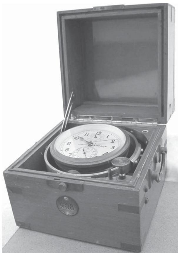
Рис. 1.13. Морской хронометр
